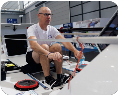
Messung der Druckverteilung während des Ruderns in einem ozeantauglichen Ruderboot
